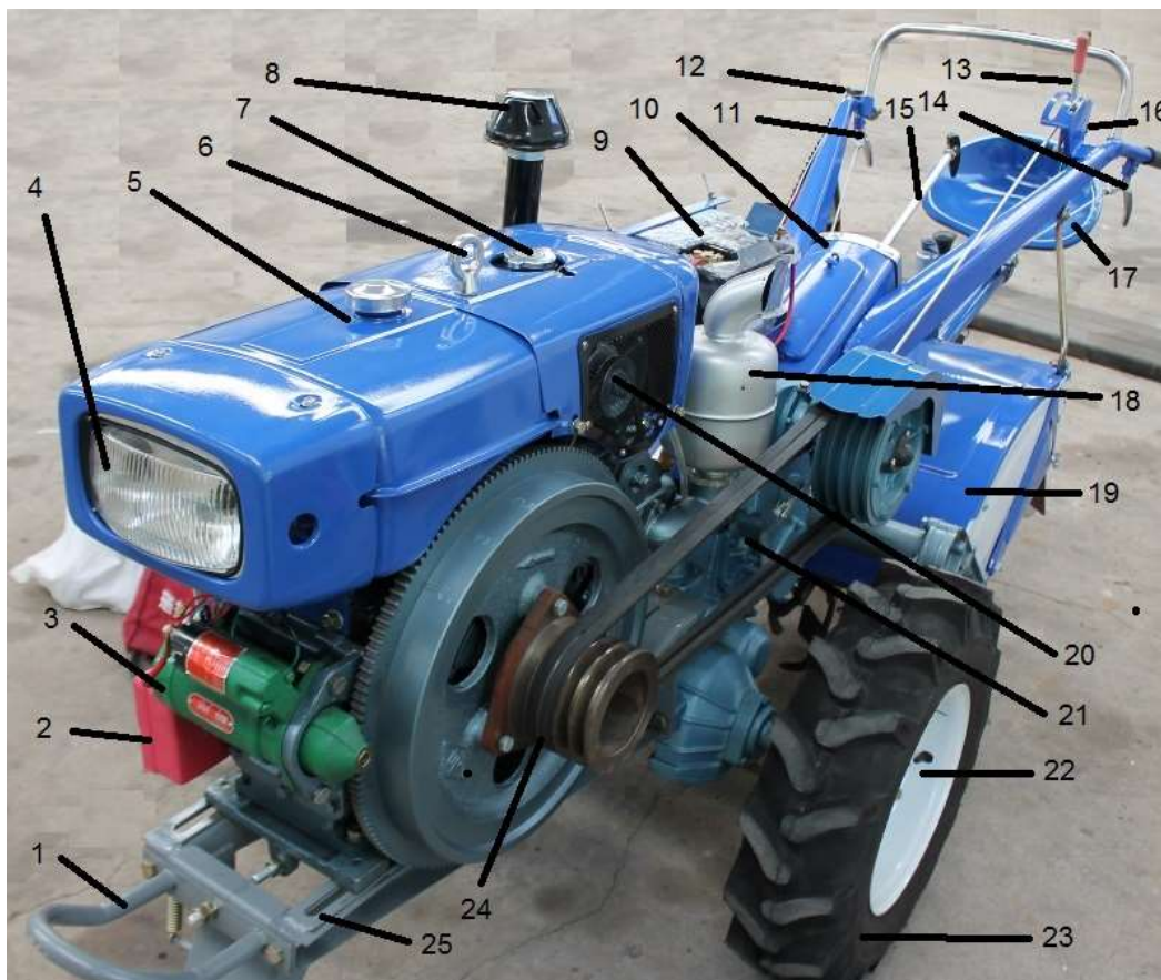
Figura 1: Principais partes e componentes do microtrator
